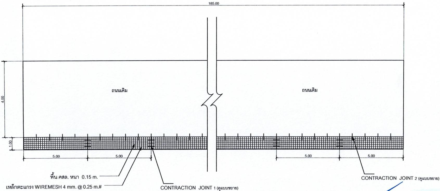
รูปแปลนคอนกรีตเสริมเหล็ก กว้าง 1.00 m. ยาว 800 m. หน้า 0.15 m.
